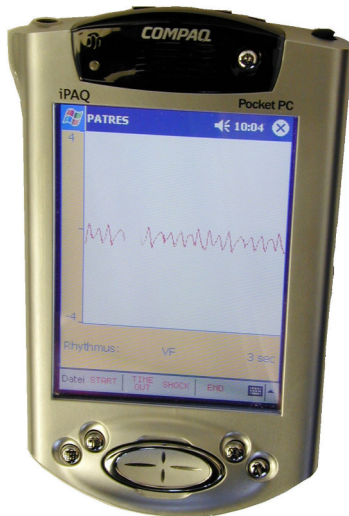
PDA als Steuergerät
